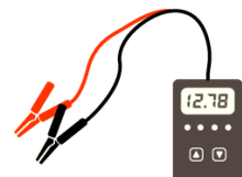
バッテリー専用テスターで定期的に状態を確認し、必要に応じて充電する。
